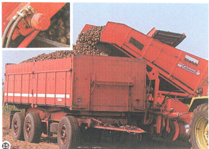
Рис. 14 15 16 Бункер с донным транспортёром вмещает 4,5 тонны картофеля. Он имеет варируемую высоту выпуска до 3,3 м. У DR 1500/III бункер с донным транспортёром подвешен вверх, иначе чем у обычных комбайнов. Это даёт больше места для манипулирования при опорожнении, даже с очень высоким автомобилем, так как насыпной конус при любом положении бункера всегда можно установить в центре кузова. Время опорожнения бункера с донным транспортёром составляет всего 20 секунд. Привод осуществляется через гидромотор. Два гидроцилиндра приводят бункер в желаемое положение для разгрузки. С помощью двух других гидроцилиндров можно сложить бункерную головку и привести комбайн в транспортное положение. Гидравлические функции управляются посредством электромагнитных вентилей.
