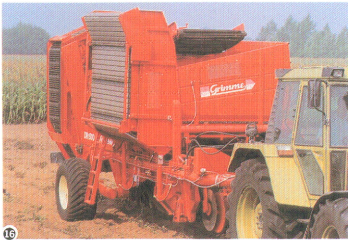
Рис. 14 15 16 Бункер с донным транспортёром вмещает 4,5 тонны картофеля. Он имеет варируемую высоту выпуска до 3,3 м. У DR 1500/III бункер с донным транспортёром подвешен вверх, иначе чем у обычных комбайнов. Это даёт больше места для манипулирования при опорожнении, даже с очень высоким автомобилем, так как насыпной конус при любом положении бункера всегда можно установить в центре кузова. Время опорожнения бункера с донным транспортёром составляет всего 20 секунд. Привод осуществляется через гидромотор. Два гидроцилиндра приводят бункер в желаемое положение для разгрузки. С помощью двух других гидроцилиндров можно сложить бункерную головку и привести комбайн в транспортное положение. Гидравлические функции управляются посредством электромагнитных вентилей.
