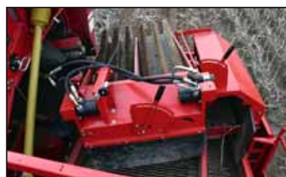
SB 900, двойная щетка (опция): улучшение качества сепарации на каменистых почвах
