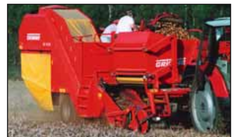
SE 75-30: для средних и больших площадей, компактная конструкция, бункер ёмкостью 3000 либо 3300 кг.
