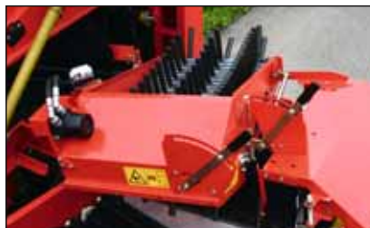
Скорость пальчикового и игольчатого транспортеров регулируется бесступенчато.
