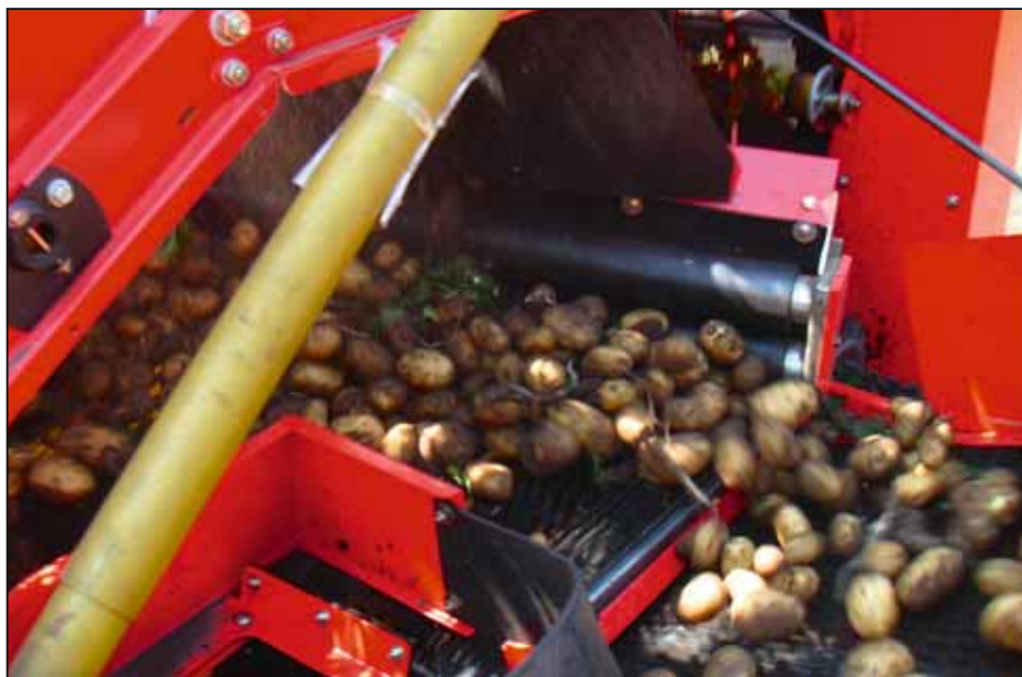
Опционально бесступенчатая регулировка с пульта управления: 6 удерживающих гребёнок (3 сверху и 3 снизу) над ботвоудаляющим транспортёром.
