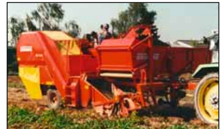
SE 75-20: для небольших и средних площадей, особенно компактная (низкая) конструкция, бункер ёмкостью 2000 либо 2300 кг
