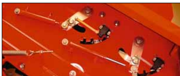
Опционально бесступенчатая регулировка с пульта управления: 6 удерживающих гребёнок (3 сверху и 3 снизу) над ботвоудаляющим транспортёром.
