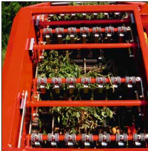
Бережная уборка урожая: транспортер для отделения крупной ботвы с мягкими скребками из полиуретана (расст. 210 мм, 280 мм).
