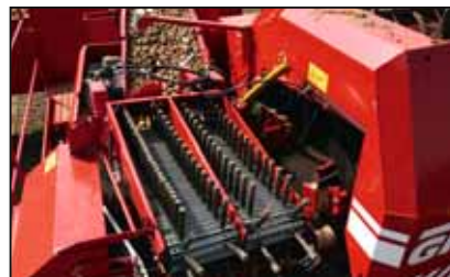
UB 900, двойной пальчиковый транспортер (опция): эффективно на сильно комковатых почвах
