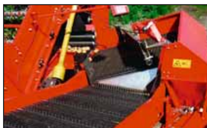
Тип NB: привод игольчатого транспортера и вальца осуществляется от гидравлики трактора.
