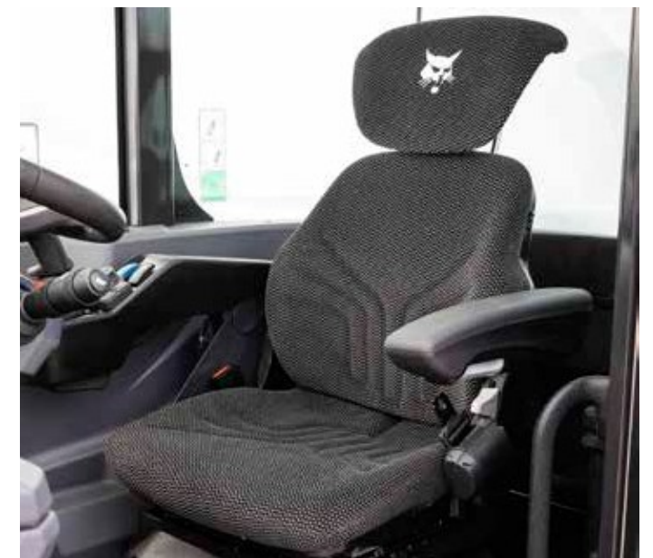
Сиденье Grammer Maximo Air с пневмоподвеской, подогревом, системой динамического демпфирования Dynamic Dumping System (DDS) и джойстиком на пружинном подлокотнике
